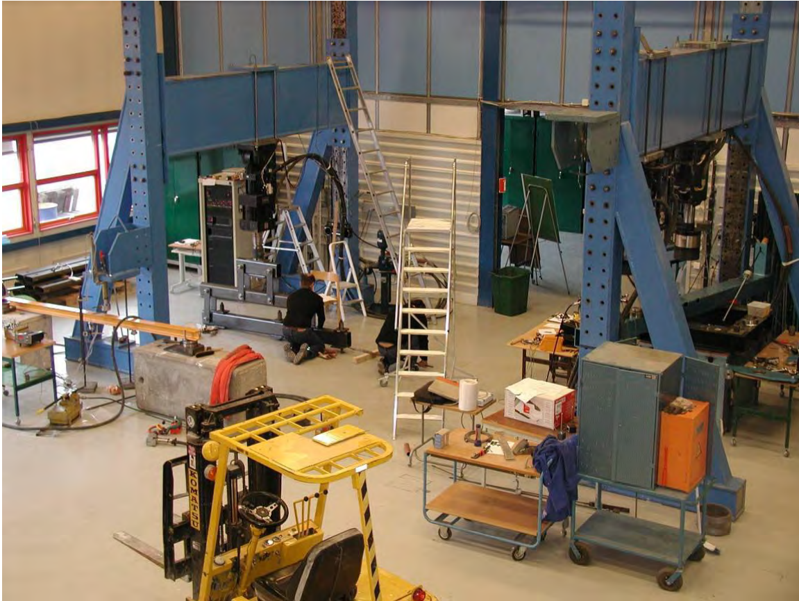
Figur 1. Bild som visar de stora flexibla belastningsriggarna (blåmålade).
