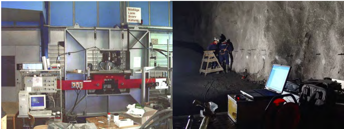
Figur 4. I bilden till vänster visas rigg för kombinerad skjuv- och normalkraft. I bilden till höger visas utdragsprovning av bergbult i LKAB:s gruva i Malmberget.
