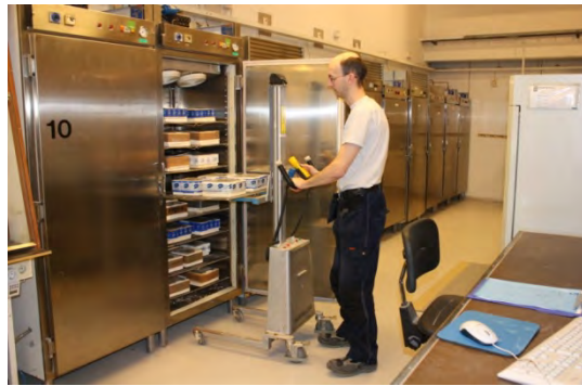
Frysskåp, provning enligt SS 13 72 44, Borås.
