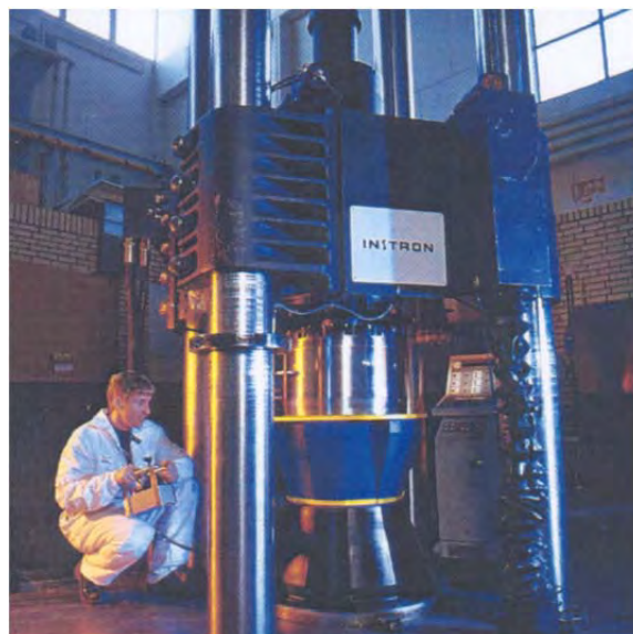
FIGUR 2. INSTRON 2008 är en mycket användbar provningsmaskin för statisk såväl som dynamisk provning. Lastkapaciteten är 1,25 MN i såväl tryck som drag och 1,0 MN vid dynamisk belastning.
