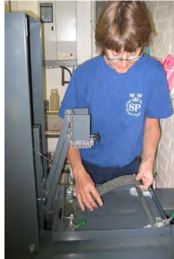
Vidhäftning skyddsbeläggning, Borås.
