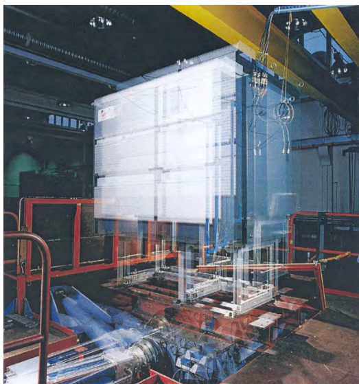
Figur 3 Den tvådimensionella skakutrustningen SKAK II används bl a för att simulera jordbävningar.
