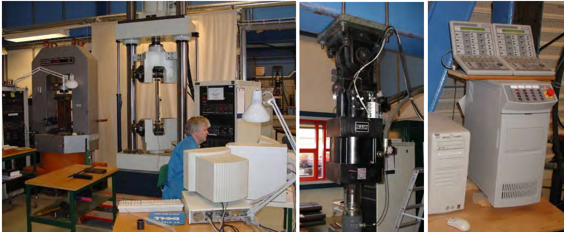
Figur 2. I bilden till vänster visas två av laboratoriets belastningsmaskiner (till vänster en Instron 4500 kN belastningsmaskin och till höger en Dartec \pm 600 kN dynamisk belastningsmaskin). De två fotografierna till höger visar en dynamisk belastningscylinder, MTS \pm 750 kN, och en tvåkanalig styrenhet, Instron 8800 labtronic.
