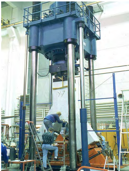
FIGUR 1. SPs största belastningsmaskin har en maximal lastkapacitet i tryck på 20 MN, i drag på ca 10 MN och dynamiskt på \pm 10 MN.
