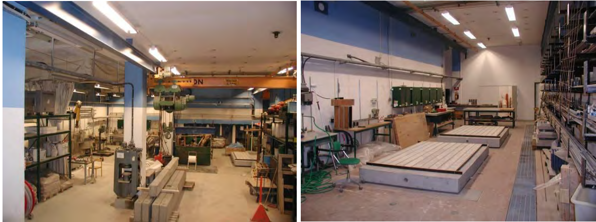
Figur 3. I bilden till vänster visas "betonghallen" där betongen tillverkas. I bilden till höger visas "armeringshallen". Plattorna på golvet ingår i ett forskningsprojekt som behandlar krympning av betong.
