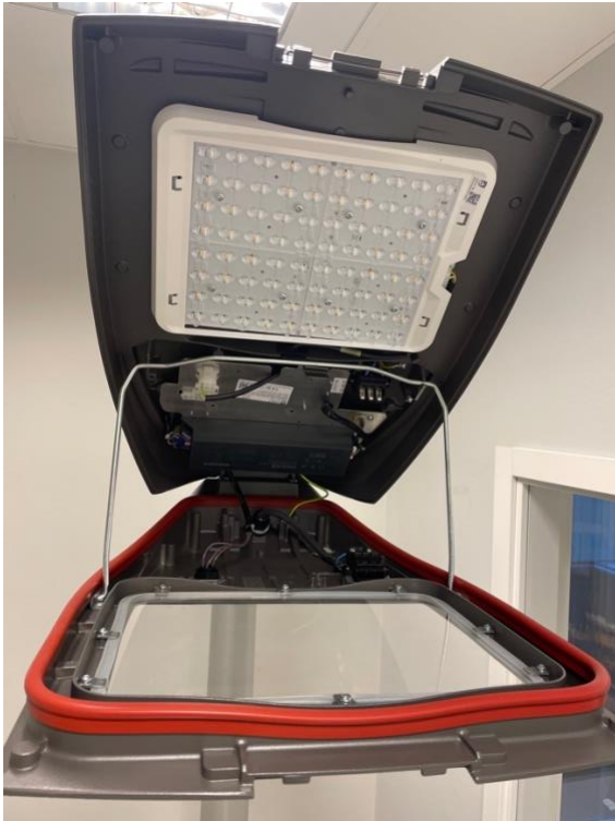
Figur 4. Gatubelysningsarmatur med LED-ljuskälla.
