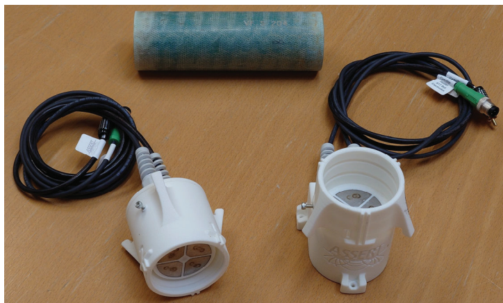
Figur 4. Lock med elektroder och temperaturgivare för icke-förstörande resistivitetmätning på material i provtagningscylindrar enligt SGF-standard (utan O-ringar monterade).
