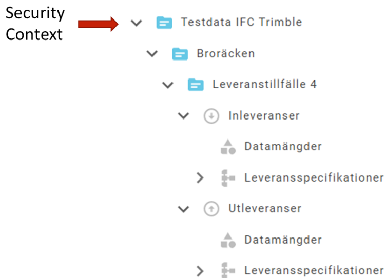
Figur 18 - Exempel på kataloghierarki där katalogen Testdata IFC Trimble definierats som ett säkerhetskontext
