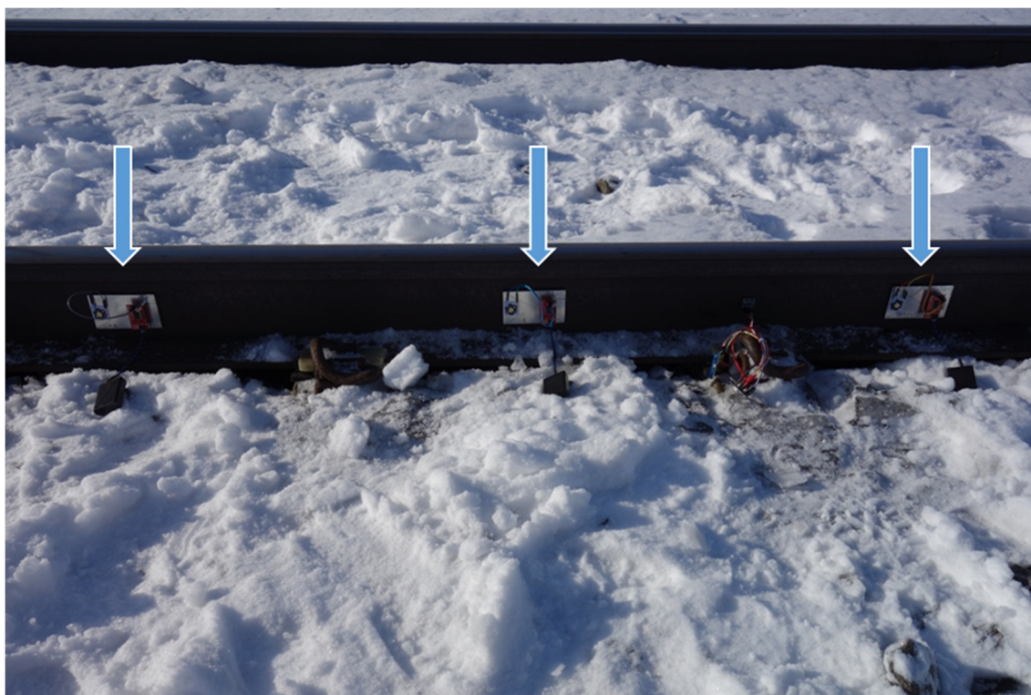
Figur 4.1. Dataloggers och accelerometrar monterade och klara före test. Se även figur 4.5 (#5).
