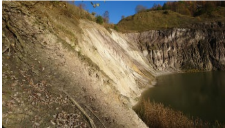
Foton från Fyleverkens övergivna täkt i Eriksdal. Fotona visar Fyledalslerans undre delar och kontakt mot underliggande Glassand. Spaden markerar provtagningspunkt.(SGU)
